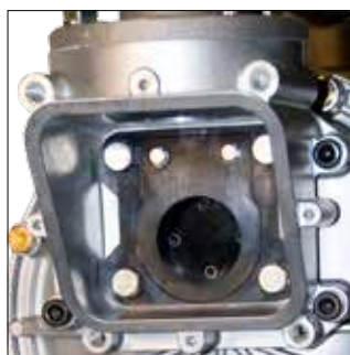
4 boulons pour accéder aux clapets plats
