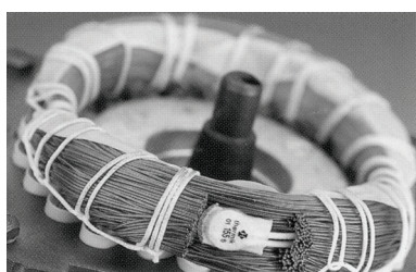
Fig. 26 Thermorupteur intégré aux enroulements
