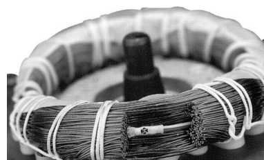
Fig. 24 Capteur PTC intégré aux enroulements
