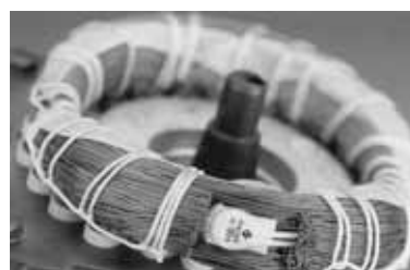
Fig. 45 Thermorupteur intégré aux enroulements
